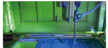
PCBA喷涂后蓝光检测
