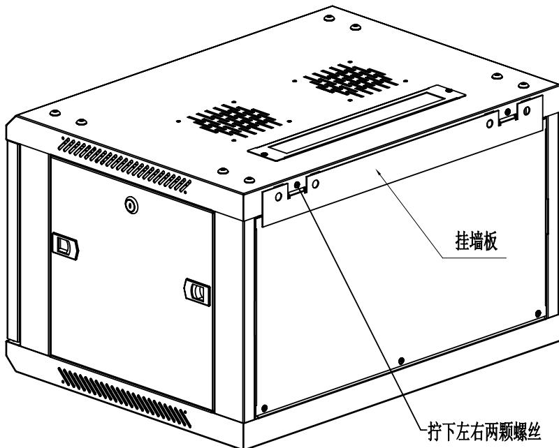
1. 拧下螺丝，拆下挂墙板
