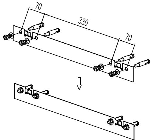
2. 在墙上打孔，安装膨胀螺丝 (M8) 和挂墙板
